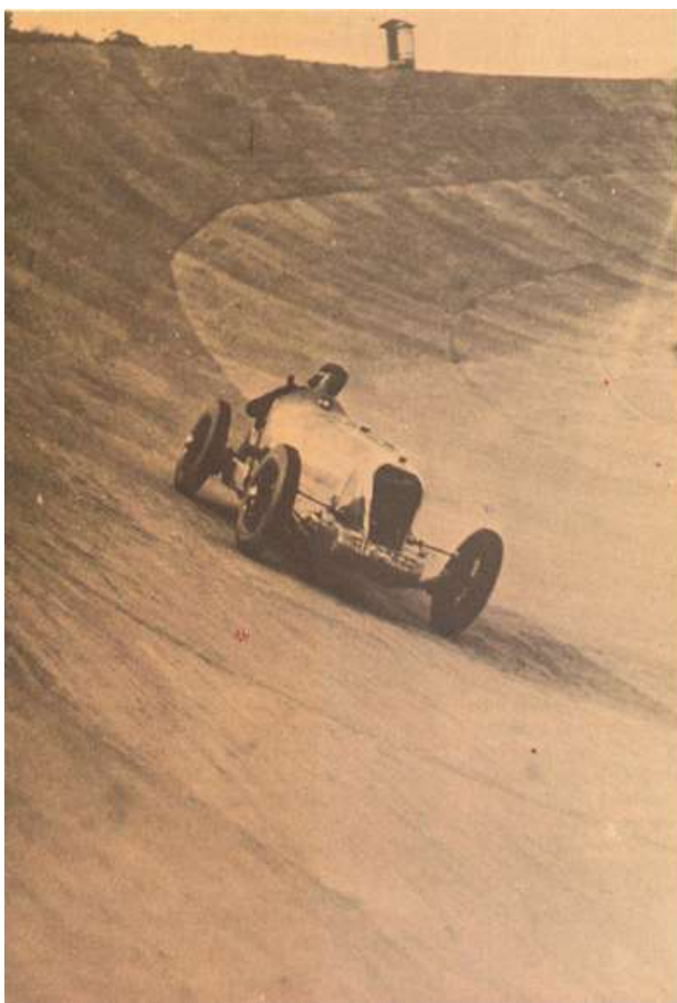
A la izquierda, aspecto del Ricart-España de 6 cilindros y 1.500 cc preparado para las competiciones; la fotografía fue obtenida en el autódromo de Sitges en 1927. A la derecha: Antes de llegar a los famosos Pegaso, los coches de mayor prestigio de W. P. Ricart fueron sin duda los modelos de 6 cilindros que llevaron su nombre como marca. Los dibujos de la época corresponden al motor y el chasis del modelo más evolucionado antes de la fusión con la marca España. Obsérvese en el chasis la disposición casi horizontal de la columna de dirección, cuestión que constituía una preocupación notable en los años veinte.
